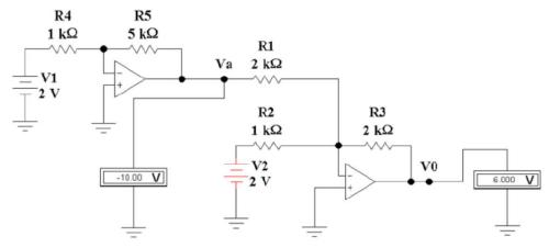
$R_1 = 2 \ k\Omega$ ,  $R_2 = 1 \ k\Omega$ ,  $R_3 = 2 \ k\Omega$ ,  $R_4 = 1 \ k\Omega$ ,  $R_5 = 5 \ k\Omega$ ,
